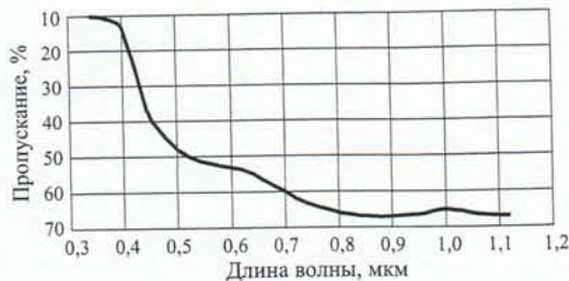
Рис. 4. Типичный спектр оптического поглощения в ванадийсодержащих стеклах системы \text{La}_2\text{O}_3 - \text{Al}_2\text{O}_3 - \text{SiO}_2
