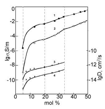
Fig. 1. Electrical conductivity and diffusion ratios of  $Na_2O$ -SiO<sub>2</sub> glasses:  $lg\sigma$ : 1 - t=300<sup>o</sup>C; 2 - t=150<sup>o</sup>C [4, p. 274]; *lgD*: 3 - t=415<sup>o</sup>C; 4 - t=300<sup>o</sup>C [5].
